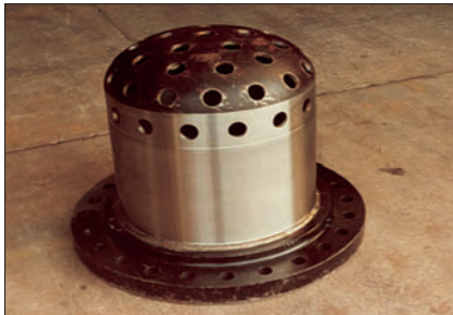
Figura 23.4: Particolare di un espansore per scarico vapore.
