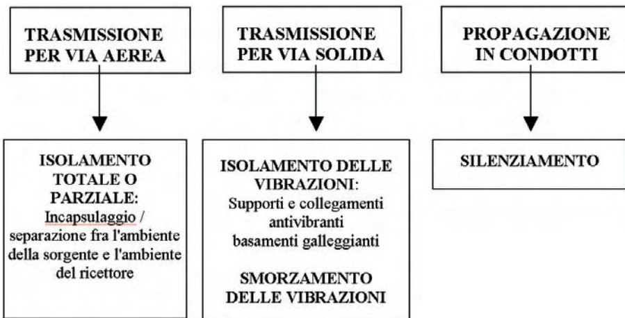
Figura 6.5: Tecniche di controllo della trasmissione sonora.
